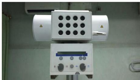
Gambar 6. Tabung pesawat Sinar-X Siemens *Luminous RF Classic*(Instalasi Radiologi RSI Sultan Agung Semarang, 2019)
